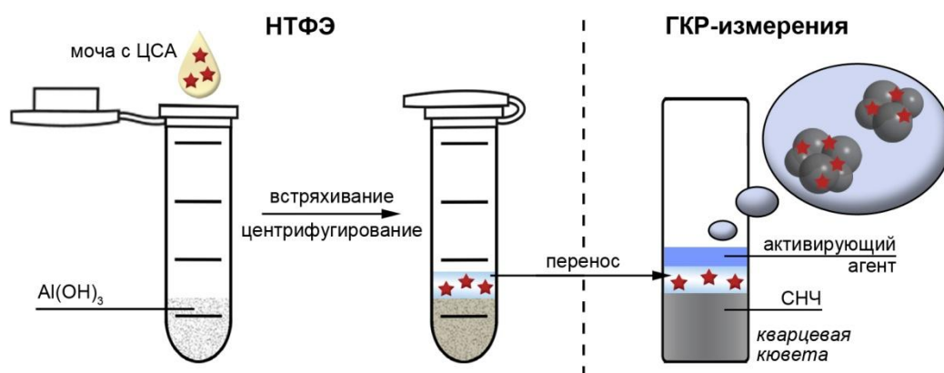
Рис. 3.9. Схема процедуры пробоподготовки образца мочи с использованием ГГА и приготовления смеси для ГКР-измерений.
