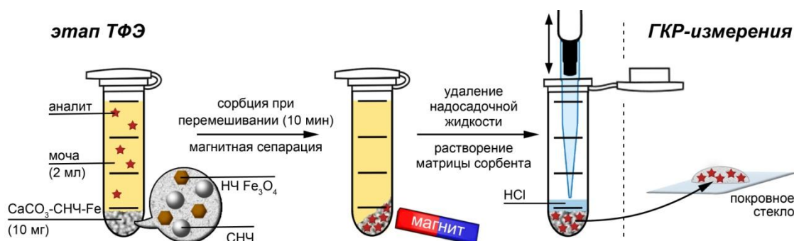
Рис. 4.34. Схема проведения детектирования САА и ЦСА в моче, основанного на совмещении ТФЭ и ГКР.
